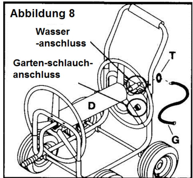
**HINWEIS:** Die Schlauchhaspel kann bis zu 91 m Gartenschlauch mit einem Durchmesser von 5/8 Zoll (16 mm) aufnehmen (Gartenschlauch nicht im Lieferumfang).
