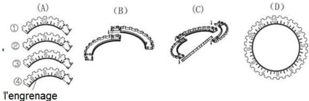
b) Placer la grande aiguille sur l'engrenage tel que montré dans la figure ci-dessous
