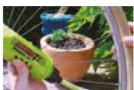
5. Drücken Sie nun die passende Menge Gel in den Schlauch (oder Reifen).
