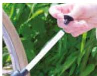
3. Ziehen Sie den Einfüllschlauch bis zum Anschlag aus der Flasche und entfernen Sie die Schutzkappe am Schlauch.
