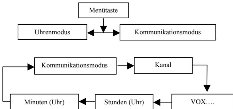
**ANMERKUNG:** Im Uhrenmodus funktioniert keine Taste, es sei denn, Sie drücken die Menütaste ca. 3 Sekunden lang, um in den Kommunikationsmodus zu gelangen
