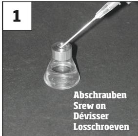
Den Glaskessel abschrauben und zu ca.  $\frac{3}{4}$  mit weichem (destilliertem) Wasser befüllen.
