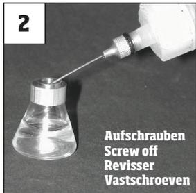
Einen kleinen Tropfen Nähmaschinen-Öl in das Wasser geben und den Kessel handfest anschrauben.
