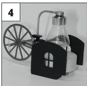
Kerze anzünden. Wenn das Wasser kocht, an der Anwerfachse mehrfach anwerfen. (Kolben und Zylinder müssen erst die Dampf Temperatur erreichen)
