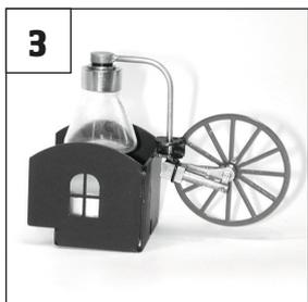
Lager, Zylindergrundplatte, Zylinder leicht ölen.
