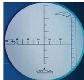
1. Pour **mesurer la distance** (la hauteur de l'objet doit être connue)
