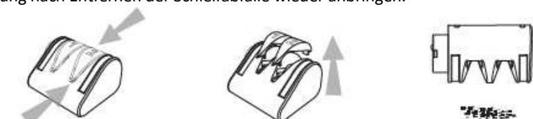
3) Schleifkopf anbringen: Schleifkopf in das Gerät einsetzen und bis zum Anschlag gegen den Uhrzeigersinn drehen.
