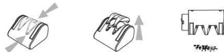
3) De slijpkop installeren: plaats de slijpkop in het apparaat en draai de slijpkop linksom tot hij niet meer verder kan.
