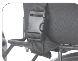
2. De lussen aan de bagagedrager bevestigen door het steeksluiting-huis door de ogen te steken en de lussen aan te trekken.
