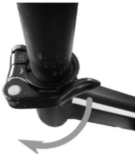
*Figure 15 : Fermeture rapide fermée*
