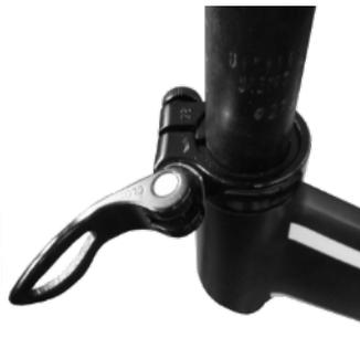
*Figure 16 : Fermeture rapide ouverte*
