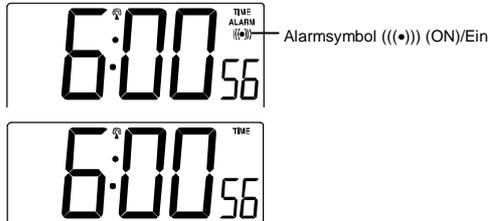
Wenn die Alarmzeit eingestellt wird, wird der Alarm automatisch aktiviert (ON). Um den Alarm zu deaktivieren (OFF), betätigen Sie im normalen Anzeigemodus einmal die **ALM**-Taste. Das Alarmsymbol verschwindet und der Alarm ist abgeschaltet.
