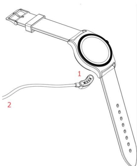
1. S'assurer que les POGO-Pins sur le câble vont bien sur les terminaux de chargement au dos de la smartwatch.
