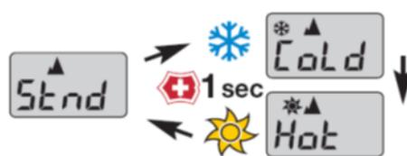
L'affichage passe ensuite en "mode compensation de température". Une brève pression sur l'emblème Victorinox permet d'accéder successivement aux réglages "Std", "Cold", "Hot".
