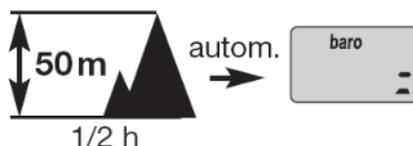
Si l'écart entre deux valeurs mesurées est trop important (écart d'altitude = 50 m par ½ heure), l'affichage est automatiquement réinitialisé. En effet, on part alors du principe que l'écart n'est pas dû à un changement météo mais à un changement d'altitude.
