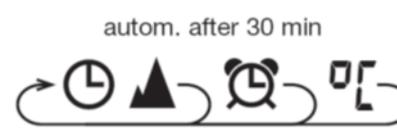
Si aucune touche des menus "Altimètre", "Réveil" et "Température" n'est actionnée pendant 30 min., l'écran retourne automatiquement en mode affichage de l'heure.
