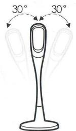
Der Lampenkopf kann seitwärts angepasst werden (rechts/links) innerhalb eines 60 Grad-Winkel (30 Grad nach links und 30 Grad nach rechts).
