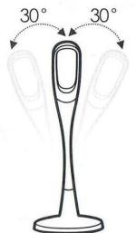
La tête de la lampe peut être ajustée latéralement (droite / gauche) dans un angle de 60 degrés (30 degré à la gauche et 30 degrés à la droite).
