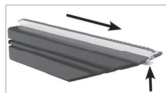
4. Verwijder de slijpsteen uit de greep: de vergrendeling op de slijpsteen indrukken en deze uit de greep eruit trekken. Indien nodig met de duim van de andere hand een handje helpen en tegen het andere uiteinde van de slijpsteen drukken.
