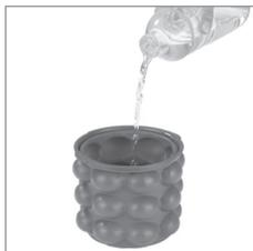
1. Die Eiswürfelform bis zu den Markierungen mit Trinkwasser befüllen. Alternativ kann der Kunststoffbehälter bis zur **MAX**-Markierung befüllt und das Wasser in die Eiswürfelform umgefüllt werden.
