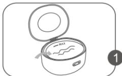
1)Open het deksel en vul de roestvrijstalen tank met water.
