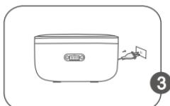
3)Sluit het deksel, en sluit het netsnoer aan op een stopcontact.
