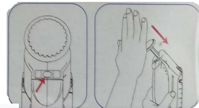
6. Om een spijker uit de muur te halen, de inkeping op gelijke lijn met de spijker plaatsen en trekken.
