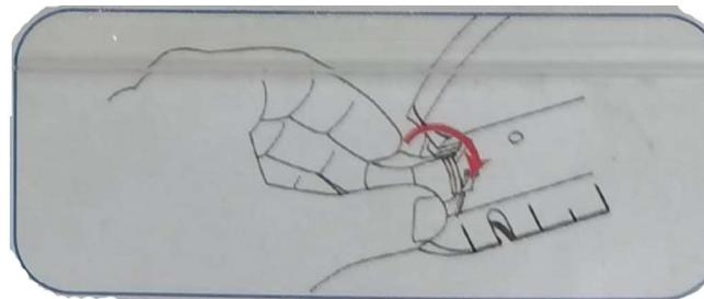
6. Um einen Nagel aus der Wand zu entfernen, die Rückzugkerbe mit dem zu entfernenden Nagel ausrichten.
