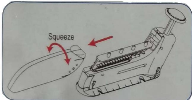
3. Um den Streifen Nägel einzulegen, die Kappe am Federende gegen den Uhrzeigersinn drehen, um sie zu entfernen. Den Streifen Nägel in das Magazin legen. Sich dabei versichern, dass sie in die gleiche Richtung wie das Nagelsymbol an dieser Stelle geneigt sind.
