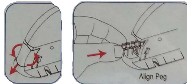
2. Die Nägel in das Magazin füllen. Die Haken wie auf der Abbildung auf den Bolzen fixieren. Die Nagelabdeckungen in hinten liegenden Zonen beiderseits des Magazins einlegen. Die Nägel müssen schräg eingelegt werden. Zuerst in Richtung unterer Rand, dann drücken, bis sie einrasten.
