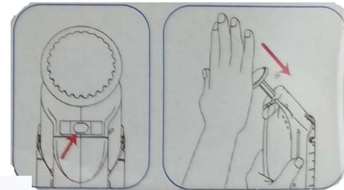
4. Die Kappe einsetzen und durch Drehen verriegeln.
