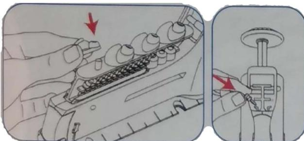
3. Om het magazijn te laden, de dop verwijderen door aan het uiteinde van de veer tegen de klok in draaien; de spijkers in het magazijn doen, en ervoor zorgen dat de punten naar dezelfde richting wijzen als het icoon dat op deze plek is afgebeeld.
