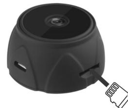
Insérez la carte micro SD dans la fente jusqu'au « clic » comme sur le schéma ci-contre (si besoin munissez-vous d'un stylo).
