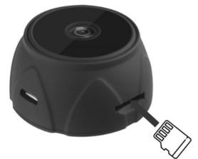
Führen Sie die Micro-SD-Karte wie nebenstehend abgebildet in den Kartensteckplatz ein, bis sie einrastet (helfen Sie bei Bedarf mit einem Stift nach).
