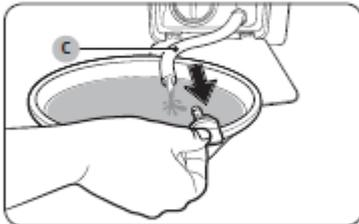
4. Öffnen Sie die Verschlusskappe und lassen Sie das Wasser über den **Notentleerungsschlauch (C)** in das bereitstehende Gefäß ab.
