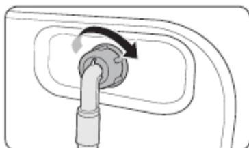
2. Schließen Sie das andere Ende des Frischwasserschlauchs an das Wassereinflussventil auf der Rückseite der Waschmaschine an. Drehen Sie das Anschlussstück im Uhrzeigersinn, um den Schlauch zu befestigen.
