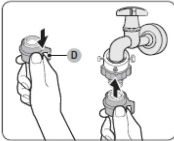
6. Ziehen Sie Teil (D) am Wasserhahn nach unten, und verbinden Sie den Wasserhahn mit dem Adapter. Lassen Sie Teil (D) dann los. Der Schlauch rastet hörbar am Adapter ein.
