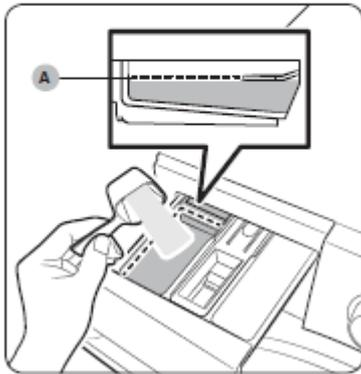
1. Ziehen Sie die Waschmittelschublade zum Öffnen heraus.
