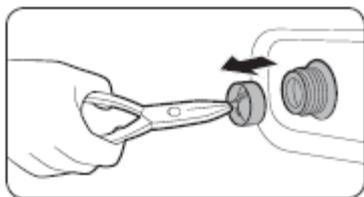
4. Ziehen Sie das Sieb mit einer Zange aus der Öffnung des Wassereinflussventils.
