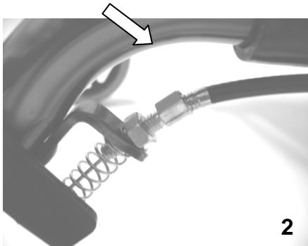
*En cas d'un freinage trop faible ou trop brusque, le frein peut être réglé à la tension voulue soit au niveau du boîtier en haut (illustration 1), soit au niveau du contre-écrou du câble Bowden en bas (illustration 2) à l'aide d'un outil approprié (non compris dans la livraison).*
