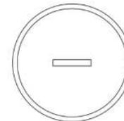
Münze in dem dafür vorgesehenen Schlitz nach rechts drehen. Deckel abnehmen. Batterie SR626SW ersetzen und den Deckel wieder eindrehen.
